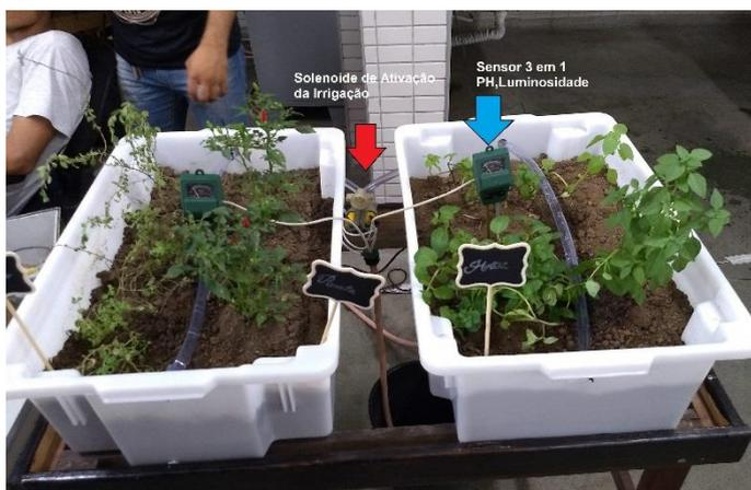
Figura 4 – Sensor 3 em 1 e solenoide de irrigação.
